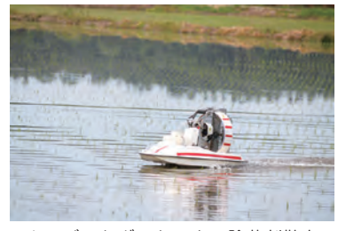
▲ラビットボートによる除草剤散布
