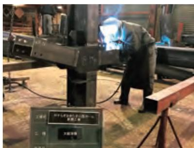
鉄骨柱大組溶接状況
